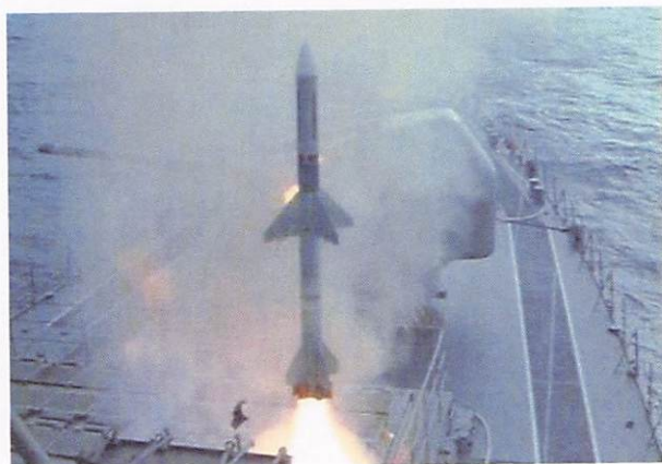
垂直式短SAM発射装置 ( VLS for Short range SAM ) 近接する対空目標に対処する対空ミサイルを発射する装置です。
