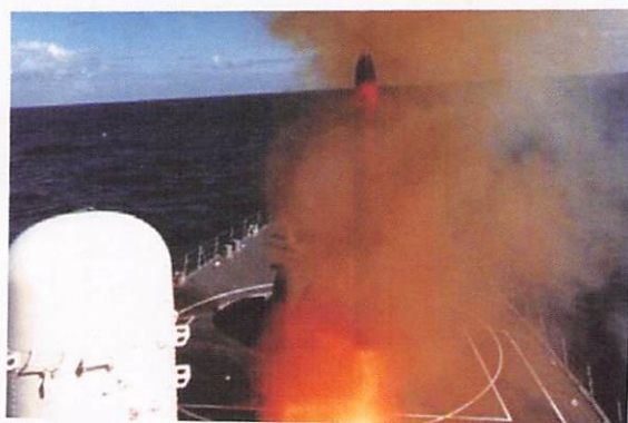
垂直式アスロック発射装置 ( VLS for Anti Submarine Rocket ) 遠距離で探知した潜水艦に対し、攻撃用魚雷にロケットを装着したアスロック (VLA) を発射する装置です。
