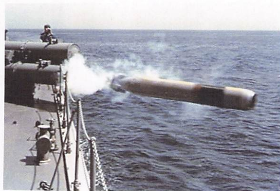
3連装短魚雷発射管 ( Triple Torpedo Tubes ) 潜水艦攻撃用の魚雷を圧縮空気で発射する装置です。
