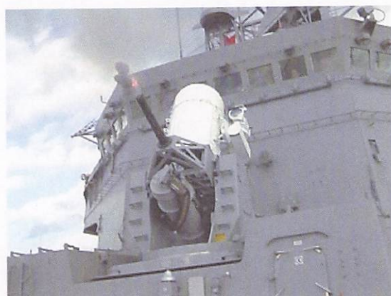
高性能20ミリ機関砲 ( 20mm Close-in Weapon System ) 近接する対空、対水上目標に対処する自動機関砲です。
