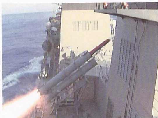
艦対艦ミサイル発射装置 ( SSM Canister Launchers ) 艦艇を攻撃するための対艦ミサイルを発射する装置です。
