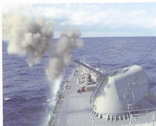
54口径127ミリ速射砲 ( 127mm rapid fire Gun ) 対空、対水上目標に幅広く対処する砲です。
